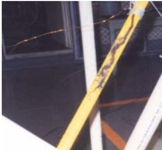
Figura 4.4 Tracking sobre una pértiga dieléctrica fallada
