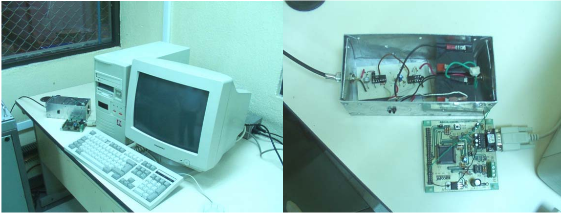
Figura 2.5 Sistema de adquisición de datos, a) Vista general , b) Aspecto del offset y del microprocesador
