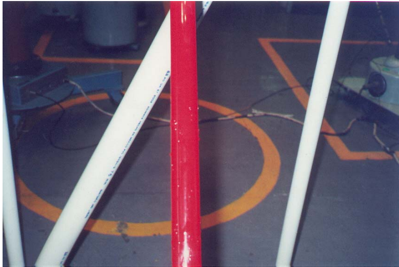
Figura 4.3 Aspecto de una pértiga de resina epoxy después de haber sido evaluada
